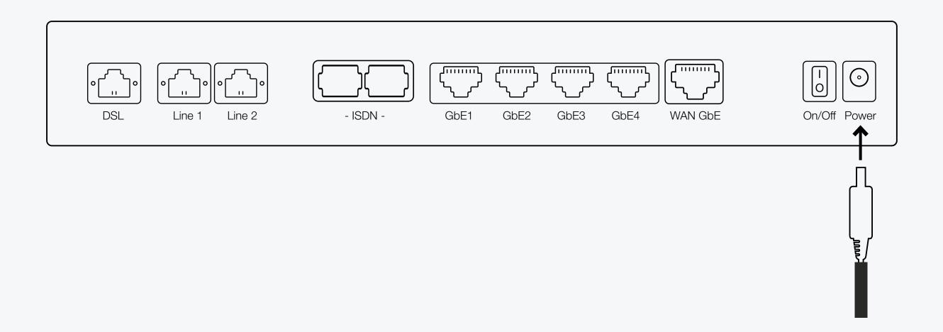
Schalten Sie das Modem mittels des On/Off Druckschalters (auf der Rückseite des Geräts) ein.
