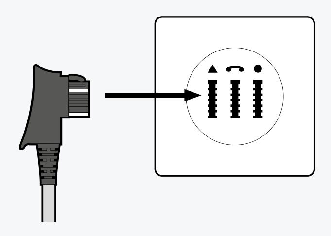
Wichtig: Sollten Sie über mehrere Telefonsteckdosen verfügen, muss das Modem an die Haupttelefonsteckdose angeschlossen werden.
