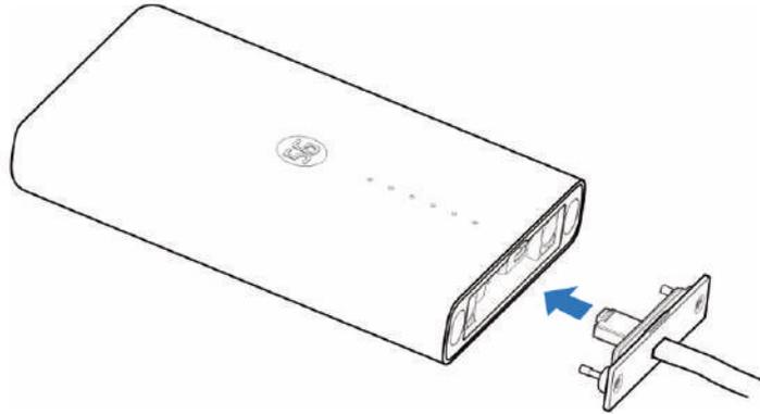
2. Schieben Sie die Abdeckung nach oben, bis das Gehäuse komplett abschließt. Verwenden Sie den mitgelieferten Stiftschlüssel, um die Abdeckung am Gerät festzuschrauben und zu sichern.
