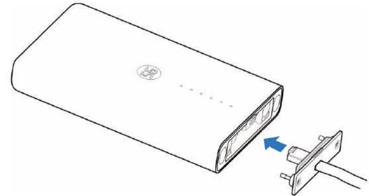
2. Schieben Sie die Abdeckung wieder nach oben, bis das Gehäuse komplett abschließt. Verwenden Sie dann den mitgelieferten Stiftschlüssel, um die Abdeckung am Gerät festzuschrauben und zu sichern.
