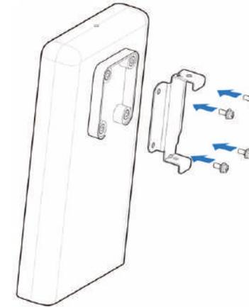
4. Befestigen Sie das Gerät an der an der Wand installierten Halterung durch den oberen und unteren Schlitz. Richten Sie dabei die Schraubenöffnung auf der Rückwand-Halterung des Geräts mit der Schraubenöffnung auf der Halterung an der Wand aus, und verwenden Sie dann eine M3 Kreuzschlitz-Schraube, um die beiden Teile zu fixieren.
