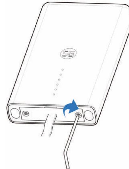
1. Schließen Sie das Flachband-Netzwerkkabel, welches bereits mit diesem Gerät (Außeneinheit, ODU) verbunden ist, an jenen RJ45-Anschluss am PoE-Adapter, der die Bezeichnung **RJ45-2 PWR LAN-OUT** trägt.
