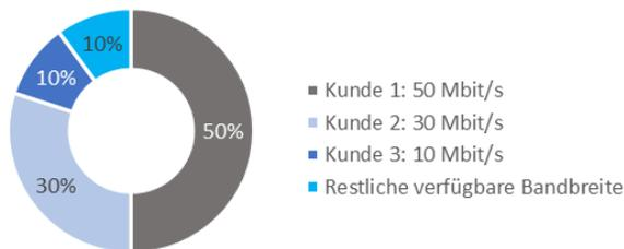
Sollte der Netzwerksektor ausgelastet sein, so wird die Netzwerkkapazität nach dem Verhältnis der jeweiligen Tarife aufgeteilt, jeweils gedeckelt mit der maximalen Tarifbandbreite.
