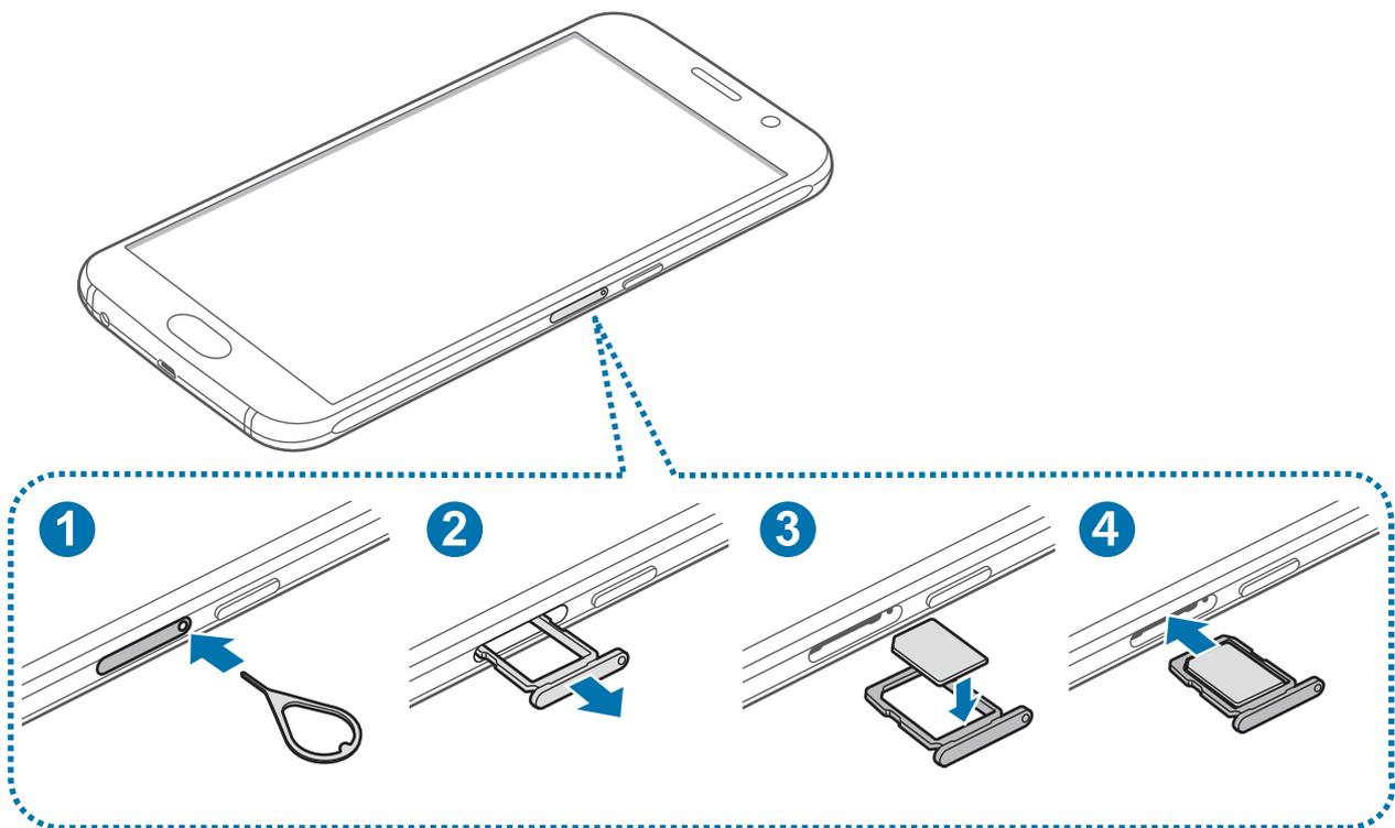
**1** Führen Sie das Steckplatzwerkzeug in die Öffnung am SIM-Kartenträger ein, um das Fach zu lösen.
