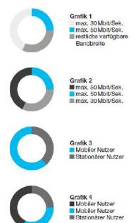
Bei ausgelasteten Sektorressourcen teilen sich die Tarife die verfügbare Bandbreite auf und erreichen teilweise nicht die maximale Bandbreite.
